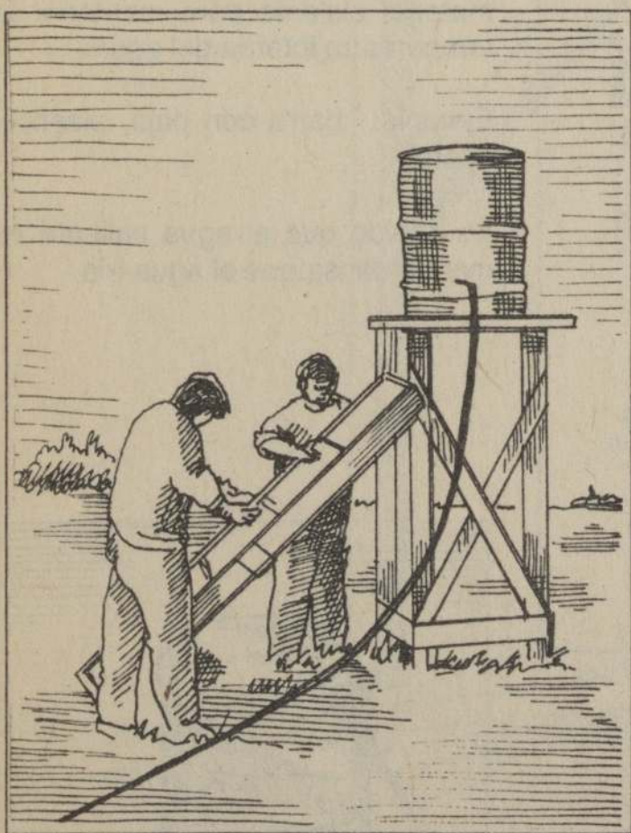
fig.81: Es bueno revisar la instalación de la placa colectora.
