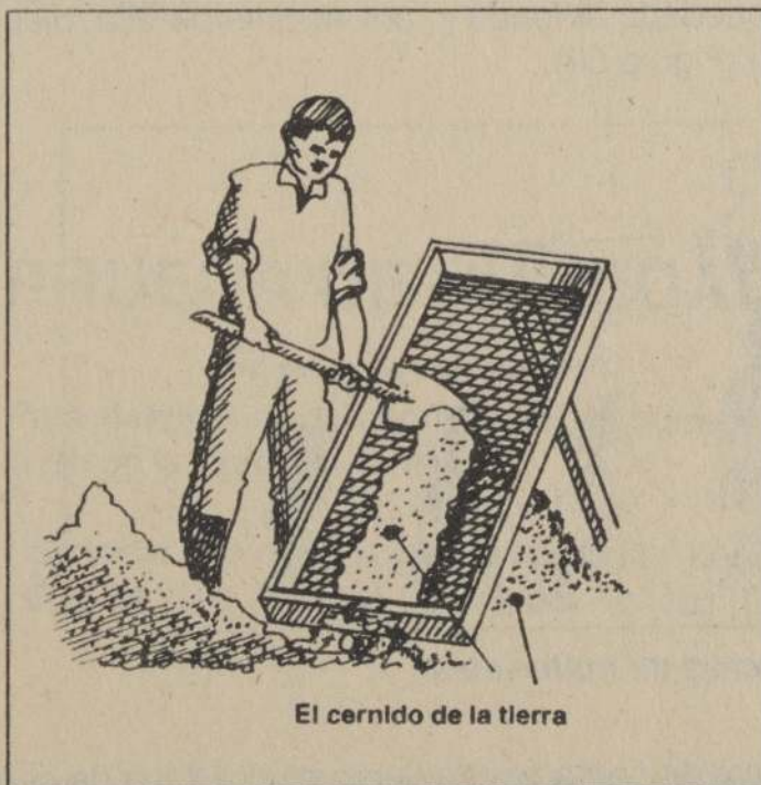
fig.58: La separación de la malla de alambre debe ser de 8 a 10 mm.
