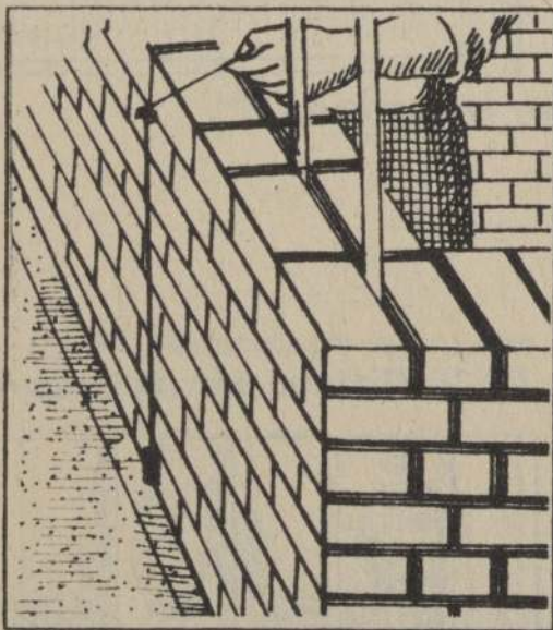
fig.31: Comprobando "línea" con la plomada.
